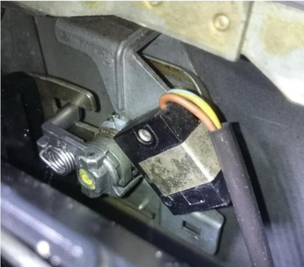
*Das ist der Mikroschalter in der Fahrertür, links ist der lange Hebel zu sehen, der das Türschloss, den damit verbundenen Stellmotor inkl. der im Stellmotor verbauten Kontakte betätigt.*
