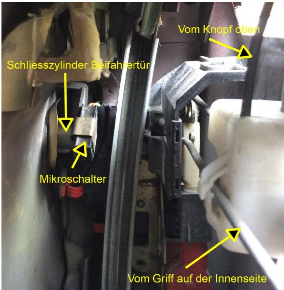
*Das Türschloss in der Beifahrertür mit den Verbindungsstangen zum Türgriff auf der Innenseite und zum Knopf nach oben. Auch hier gibt es einen Mikroschalter. In der Beifahrertür dient er auch tatsächlich zum "normalen" abschließen über die ZV.*
