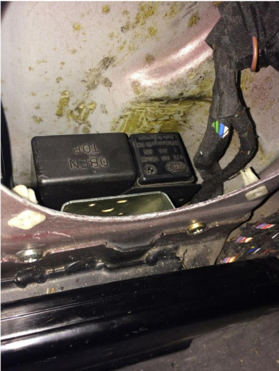
*Das Steuergerät der ZV ist gut versteckt im Schweller des Fahrerfußraums. Zum Ausbau muss vorher der Hebel der Motorhauben-Verriegelung, die Lautsprecherverkleidung und der Lautsprecher im Fußraum entfernt werden.*
