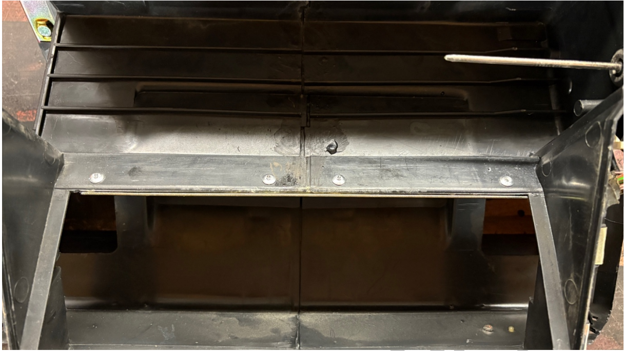
Hier sieht man die lange Halteleiste fertig eingietet auf der Unterseite des Gehäuses.
