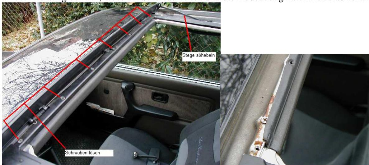
**A-Säule:** Nach Ausbau der Dachabdeckung diese oben abhebeln und nach oben abziehen.
