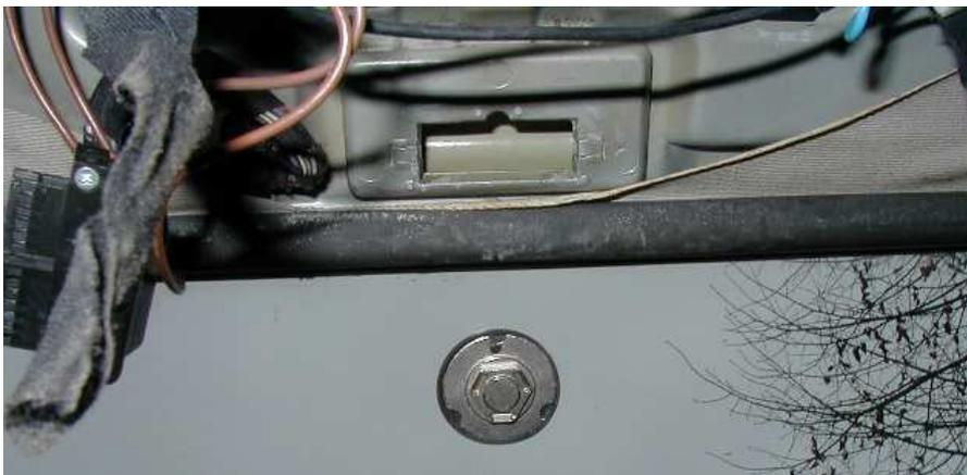
Hier sieht man die Stelle wo die Platte festgeklebt wurde. Oben ist die Öffnung für den Fuß des alten Innenspiegels zu sehen. Ebenfalls zu sehen ist die Abdeckung der Grundplatte. Ich würde diese erst nach dem Verkleben aufschieben, da diese aus Gummi ist geht das sehr einfach.
