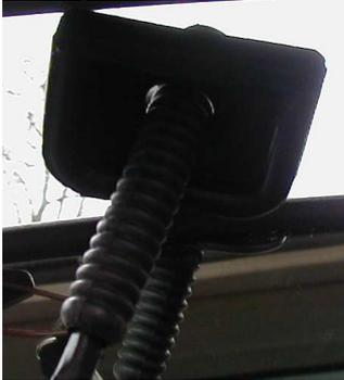
Die Kabel sollte man nun sorgfältig vom Dach über die A-Säule in den Fahrer-Fußraum verlegen.
