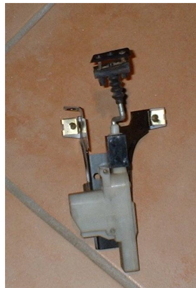
Den Schlossantrieb mit Halteblech für den Tank
