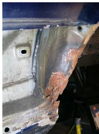
Abbildung 5: Schäden am Innenkotflügel (Seitenwand abgetrennt)
