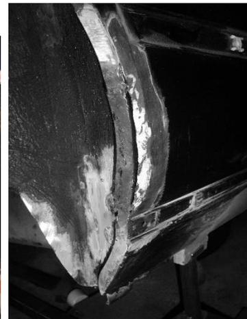
Abbildung 6: Schäden an der Radlaufkante
