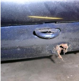
Abbildung 1: Schäden unter Abschleppöse
