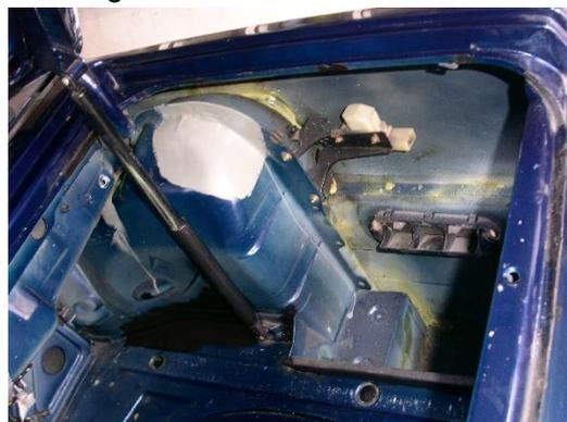
Abbildung 3: Mögliche Schäden am rechten Radkasten
