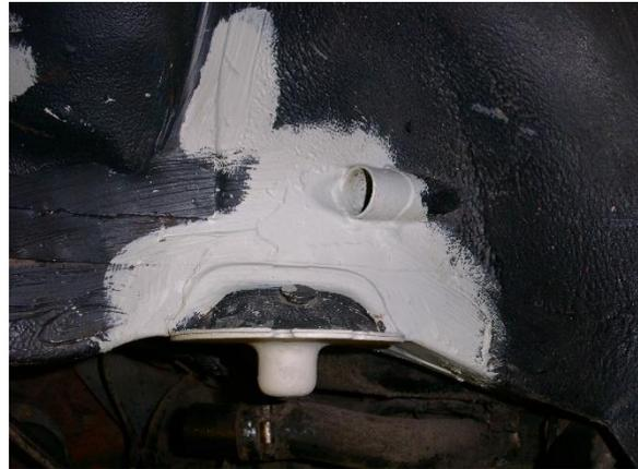
Abbildung 4: Federteller und Rohr für Entlüftungsleitungen
