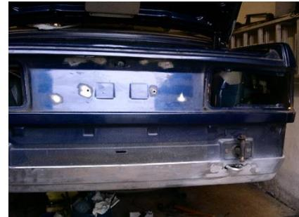
Abbildung 2: Rostnester hinter Kennzeichen und Beleuchtung
