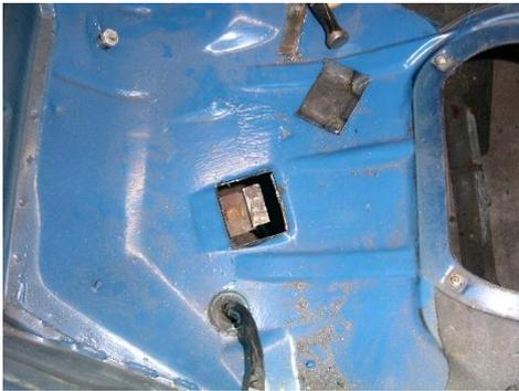
Abbildung 9: Laschen für die Befestigung des Tanks (Beifahrerseite)
