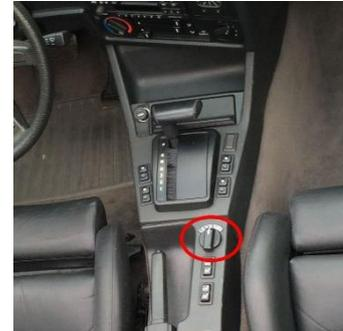
Abbildung 14: EH-Automatik mit Wahlschalter (rot Markiert)
