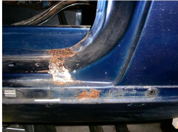
Abbildung 8: Rostschäden im Türausschnitt
