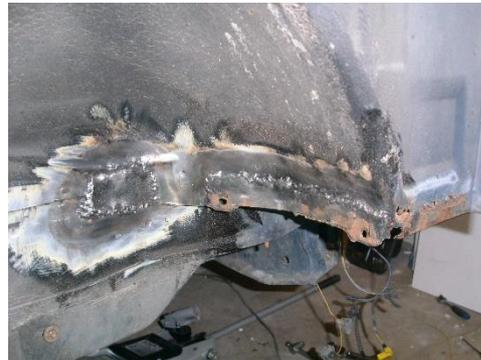
Abbildung 11: Ansicht aus dem Radkasten (mit unsachgemäßen Reparaturversuch, auch „Pfusch“ genannt ;))
