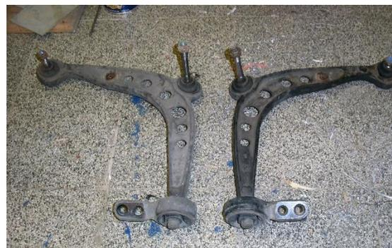
Abbildung 12: Ausgebaute Querlenker mit originalen (aber defekten) Gummilagern
