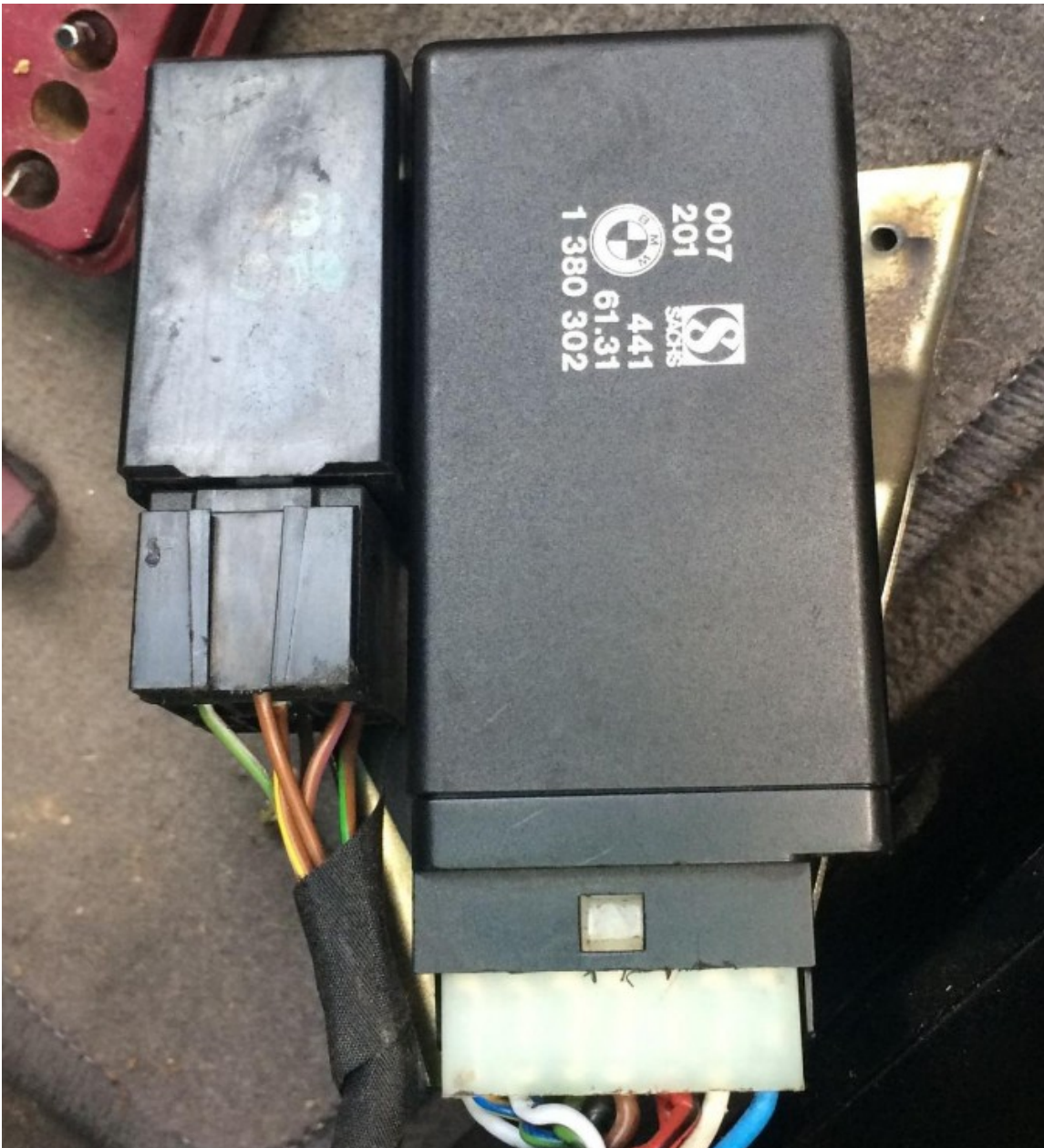
Das ZV Steuergerät, mit der Halterung und dem daneben befestigten "Komfort Relais"
