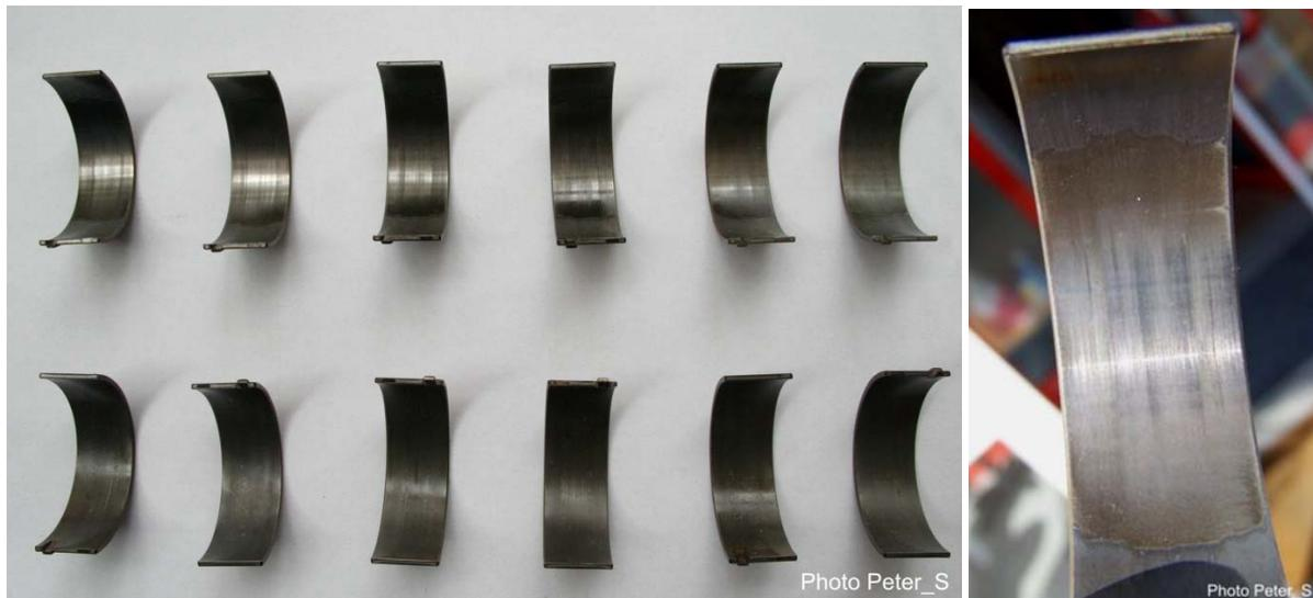
**Abb. 14-15:** Pleuellagerschalen eines M50 nach ca. 160tkm. Mann kann gut erkennen, dass die erste Schicht der oberen Schalen schon runter ist. Hier ist ein Austausch zwar noch nicht zwingend notwendig aber sinnvoll.
