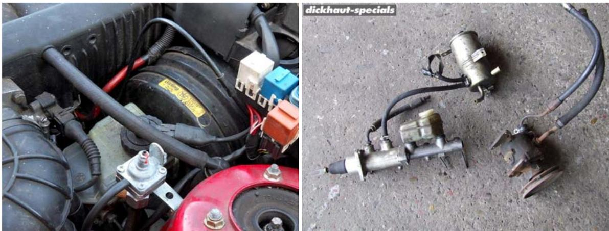
**Abb. 35-36:** Tandem-Bremskraftverstärker vom E30 325ix (links – Foto deede). Hydrobremse vom E32 750i, die beim S50-Einbau benötigt wird (rechts).
