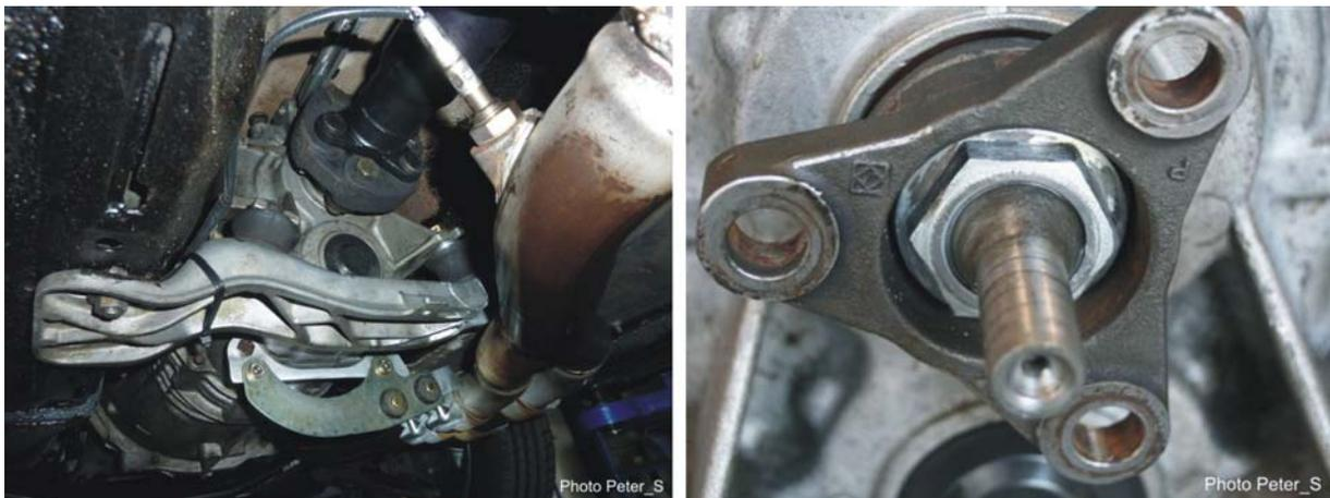
**Abb. 81-82:** Das Getriebe kann mittels des E30 M20-Getriebehalters befestigt werden, aber auch andere Traversen wie hier vom Z3 M-Roadster können verwendet werden (links). Der kleine 78 mm Getriebe-Flansch ermöglicht die Verwendung einer E30 320i/325i Kardanwelle (rechts).
