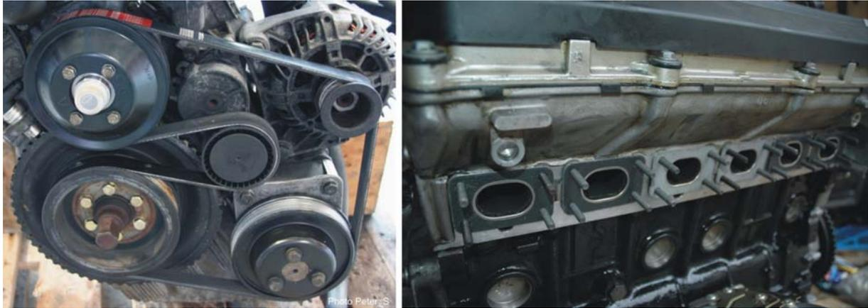
**Abb. 18-19:** Unter anderem sollten auf jeden Fall ein neuer Keilrippenriemen für den Antrieb von Ölpumpe, Wasserpumpe und Lichtmaschine (links) und neue Abgaskrümmers-Dichtungen (rechts) verbaut werden.
