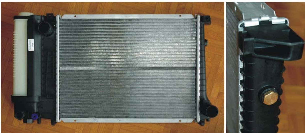
**Abb. 43-45:** M20-Kühler mit separatem Ausgleichbehälter (oben), E36-Kühler mit integriertem Ausgleichbehälter und Anschluss für Temperaturegeber (unten).
