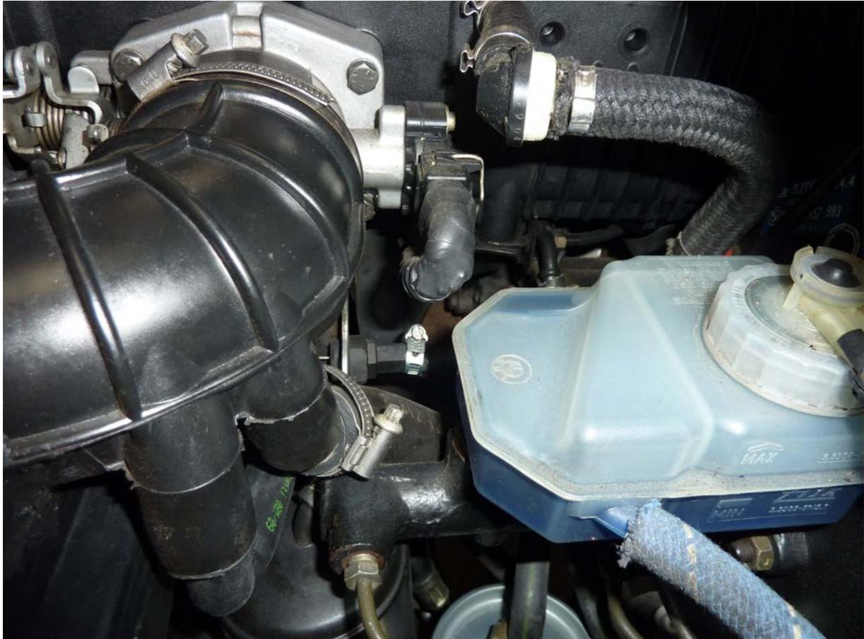
**Abb. 66:** Im E30 verwendet man am besten den Ansaug-Faltenbalg zur Drosselklappe vom E36, da er beide Anschlüsse für die Unterdruck-Steuerung am Außenbogen hat. Das Verlegen des inneren Schlauches ist recht problematisch, da der Bremskraftzylinder im Weg ist.
