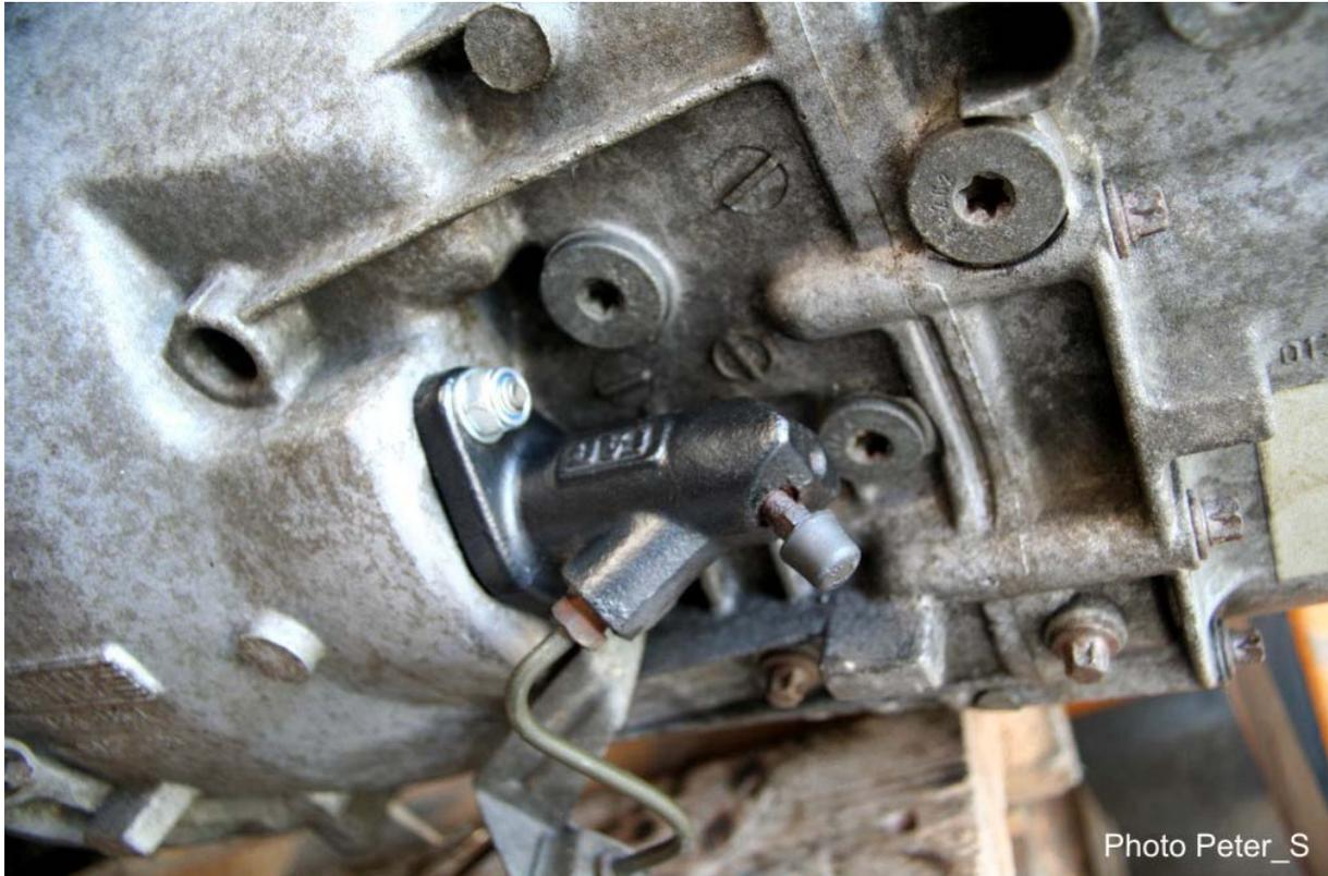
**Abb. 84:** Der Kupplungs-Nehmerzylinder muss zum verbauten Getriebe passen. Der E30 M20 bspw. kann nicht verwendet werden, weil er zu kurz ist und bei der ersten Betätigung verkantet würde.
