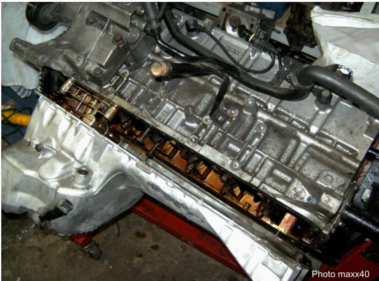
**Abb. 11:** M52B28-Motor aus dem E36 mit E34-Ölwanne
