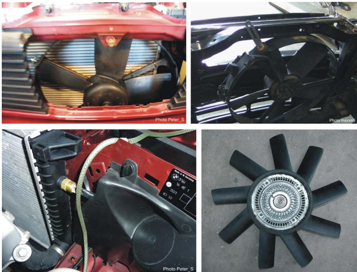
**Abb. 50-53:** Der Elektrolüfter vom E34 passt recht gut in die Frontmaske des E30 (oben). Zum Verbau eines E-Lüfters muss der Kühler unbedingt oben an der rechten Außenseite ein Gewinde für den Temperaturfühler besitzen (unten links). Soll der Viscolüfter verbaut werden, muss das Lüfterblatt verkehrt herum auf die Visco-Kupplung verbaut und alle Fächer um ca. 2 cm gekürzt werden (unten rechts).
