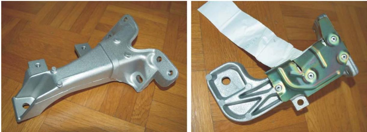
**Abb. 27-28:** E36-Motorhalter, links Absaugseite, rechts Abgasseite mit Hitzeschutzblech.
