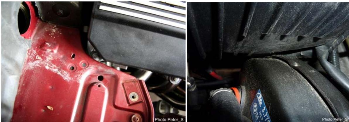
**Abb. 33-34:** Die typischen „Engstellen“ beim M50 Umbau, die u.a. durch die Motorlager angepasst werden müssen. Eng wird es besonders zwischen Zylinderkopf und Batterieblech und zur Spritzwand hin (links). Um ein paar Millimeter Luft zum Bremskraftverstärker zu schaffen, muss der Motor abgasseitig möglichst hoch verbaut und die hinteren vier Rippen am Luftsammler abgeschliffen werden (rechts).
