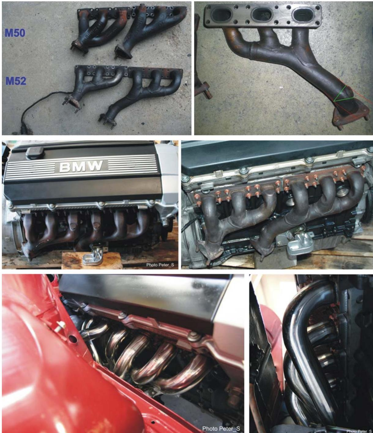
**Abb. 92-97:** M50-Gußkrümmer und M52-Blechkrümmer im Vergleich (oben links). Der vordere M52-Blechkrümmer muss wie eingezeichnet gekürzt und der Verlauf flacher gestaltet werden, wobei man am besten den Teil mit dem Gewinde für die Lambdasonde rausschneidet (oben rechts). M50-Motor mit den originalen M50-Gußkrümmern (Mitte links). M50-Motor mit den noch unbearbeiteten M52-Blechkrümmern (Mitte rechts). Fächerkrümmer „Longtube“ (unten).
