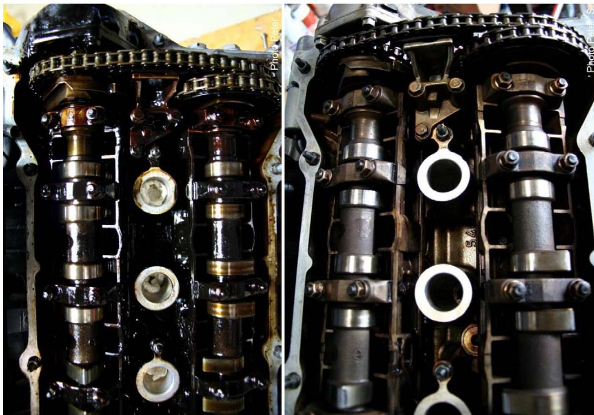
Abb. 12-13: Zylinderkopf des gleichen Motors vor (links) und nach einer Spülung (rechts)
