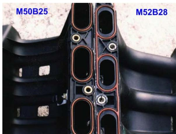
Abb. 109: Vergleich Ansaugbrücken vom M50B25 und M52B28
