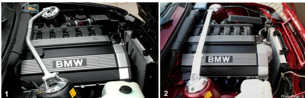
Abb. 1-2: M50-Motor (links); M50TÜ (rechts)
