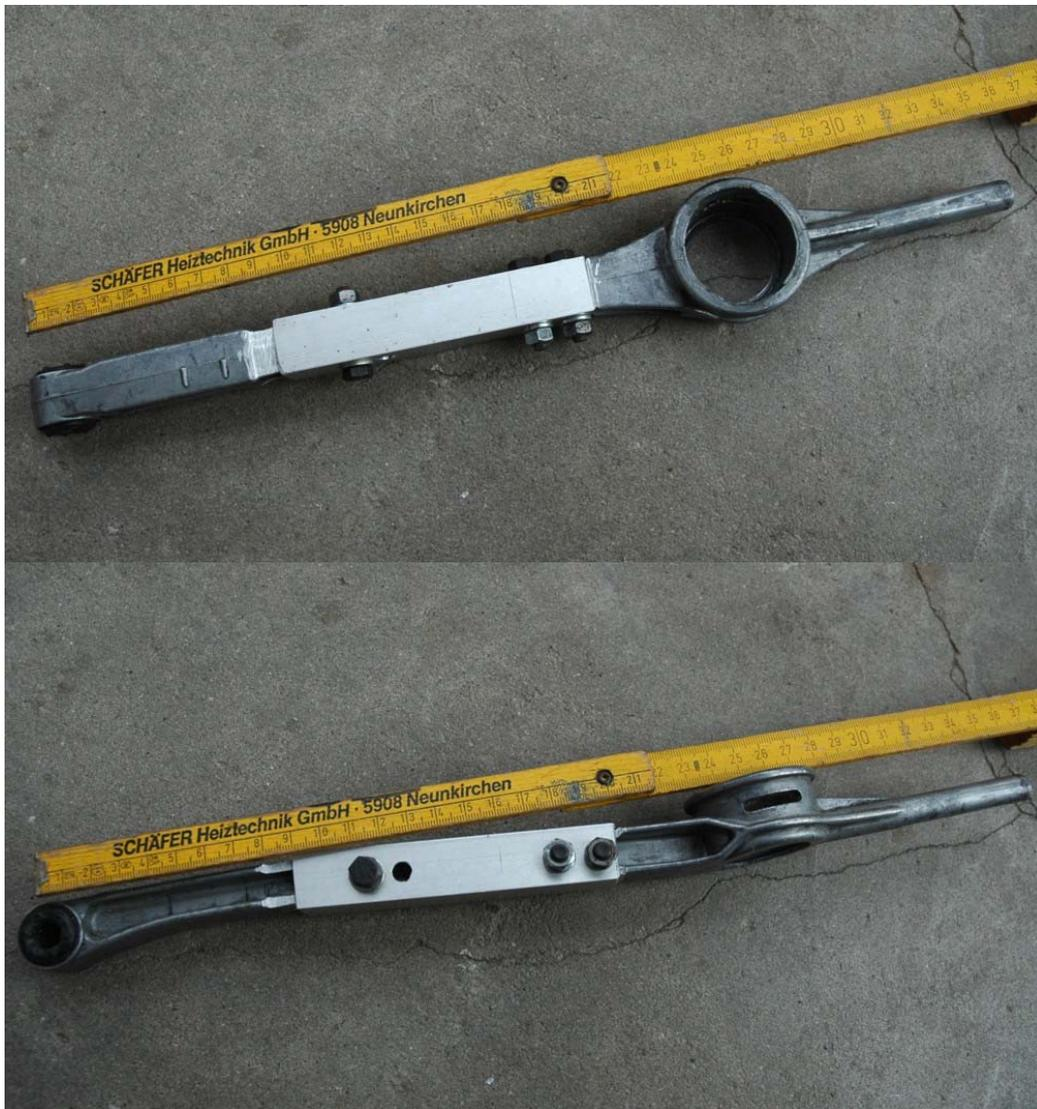
**Abb. 83:** Wenn die obere Schaltstange verlängert werden muss, kann das z.B. so aussehen. Hier wurde sie durchtrennt und die beiden Teile mittels eines Alu-Vierkanthohres miteinander verschraubt.
