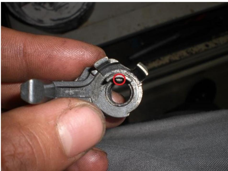
Ein leichtes einfetten mit Haft-fett verhindert das die Rolle verrutscht und erleichtert somit die Montage. Anschließend wird der Hebel inkl. Rolle auf die Welle des Zylinders geschoben.
