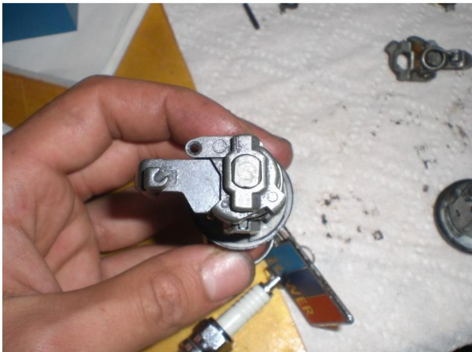
Schlussendlich wird die Rückzugfeder montiert und das Schloss ist wieder bereit für den Einbau.
