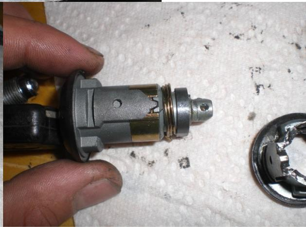
So nun muss eine kleine Rolle auf der Welle des Zylinders eingesetzt werden da sonst die vollständige Funktion des neuen Schlosses nicht gewährleistet ist.
