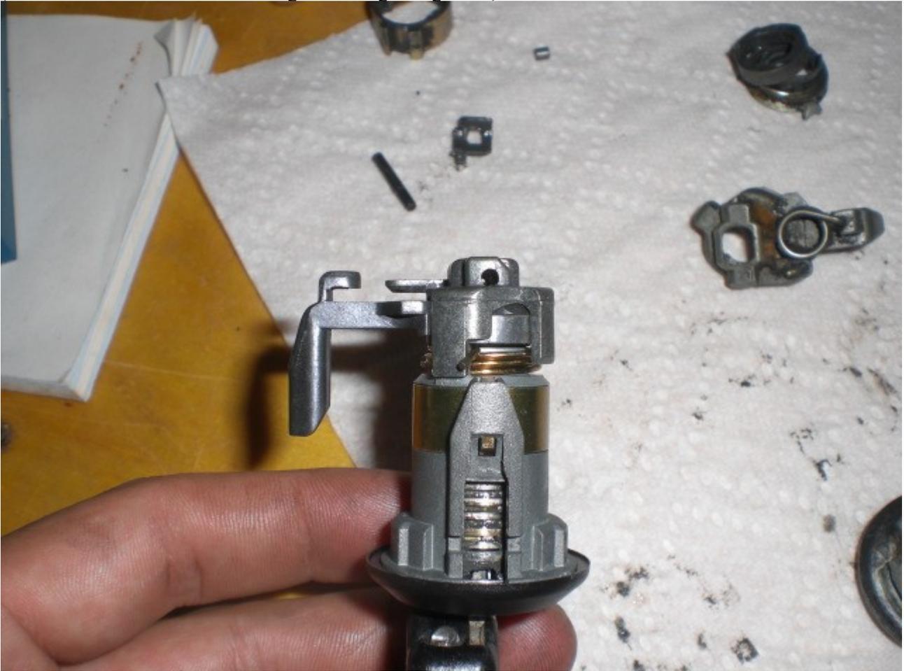
Daraufhin wird der letzte Umlenkhebel montiert und das ganze Schloss mit einem neuem Splint gesichert.
